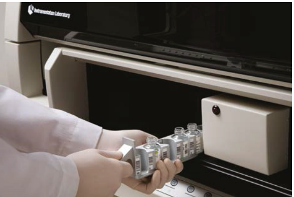
Leitor de código de barras “onboard” permitindo a gestão dos reagentes em tempo real.
